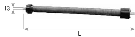
Molle di compensazione e tiro diretto per rullo 60mm Assist and Push Up Spring for 60mm Octagonal Roll
